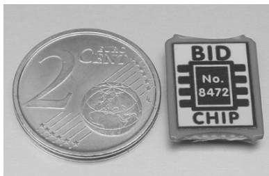
BID-Chip sin cable, para equipar otras baterías. No. 308472
