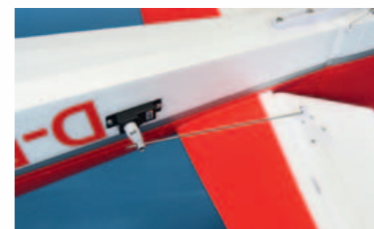
Über Federn ist die Spornradsteuerung angebracht
