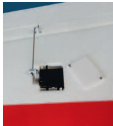
In einer cleveren Plastikhalterung ist das Querruderservo fixiert. Ein Deckel, befestigt von zwei Schrauben, sichert das Ganze
