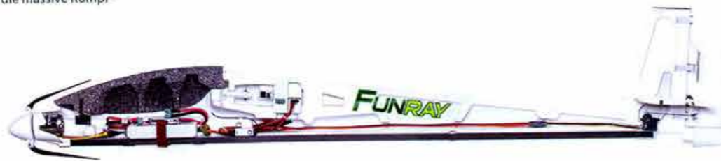
... die, wie dieses Schnittbild von Multiplex zeigt, bis ganz nach hinten zum Leitwerk läuft.
