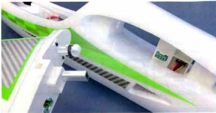
Komplett ab Werk: In der Wurzelrippe sind die Steckung, die Flächensicherung und der Stecker für die Servos integriert.
