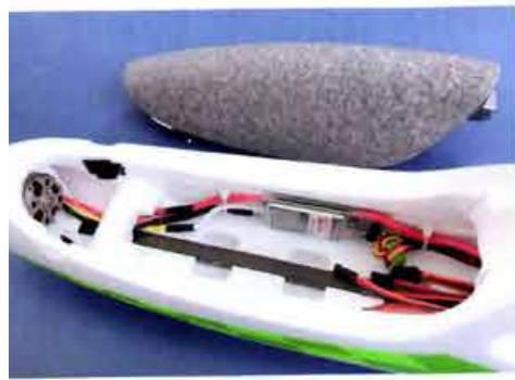
Durch die Kabinenhaube ist der Flugakku gut zugänglich. Man beachte die massive Rumpferversteifung ...
