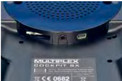
Unterhalb des Lautsprechers: die ins Gehäuse integrierte Antenne, Ohrhörer- und Mini-USB-Buchse
