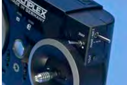
Taster für den Timer, 3-Stufen-Schalter für die Flugphasen und 2-Stufen-Kippschalter befinden sich rechts
