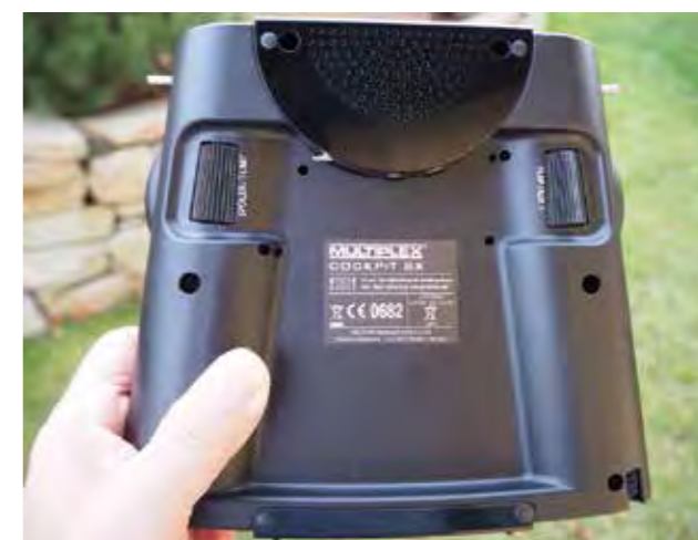
Rückseite mit Lautsprecher, USB-Buchse und Drehgeber.
