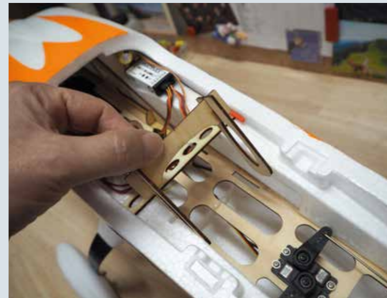
Die beiden Flächen werden mit dieser innovativen Lösung sekundenschnell arretiert.
