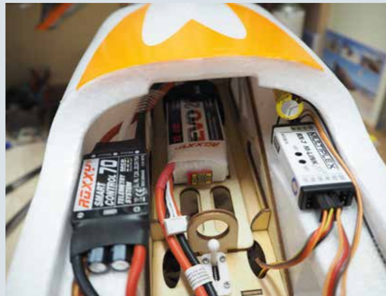
So sind Regler und Empfänger im Testmodell mit Klettband fixiert.
