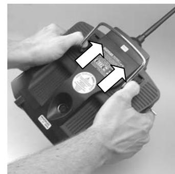
**8. POSIZIONE IDEALE DELL'ANTENNA RADIO DURANTE IL FUNZIONAMENTO**
