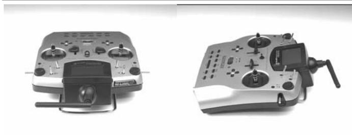
En usos en los que el modelo no se maneje directamente por encima de la emisora, o por debajo de esta (especialmente con coches o barcos), la colocación de la antena hacia arriba en vertical será la óptima.
