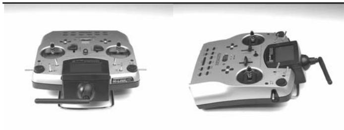
Pour les utilisations où votre modèle ne se trouve pas directement au-dessus ou en dessous de votre émetteur (surtout dans le cas des voitures et des bateaux), la position optimale de votre antenne d'émission est à la vertical vers le haut.
