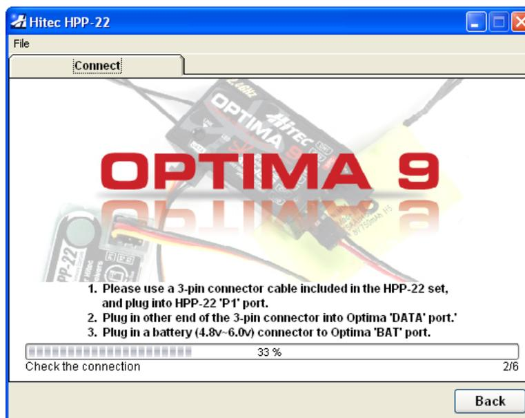
**Hinweis:** Sobald die Kabelverbindungen hergestellt sind, blinkt die rote und die blaue LED. Falls diese nicht blinken, trennen Sie die Batterie kurz vom Empfänger und stecken diese danach erneut an.
