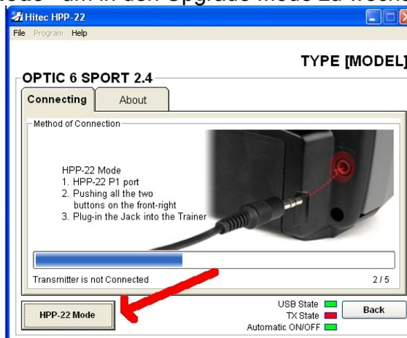
Drücken Sie die 4 Tasten rechts vom Display des Senders gleichzeitig und verbinden Sie anschließend das HPP-22 mit der OPTIC 6 Sport über das passende Anschlusskabel (Uni-Stecker auf Klinke-Stecker).
