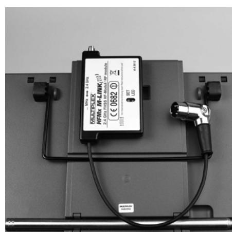
**6.3.: Branchement du module HF 2,4 GHz HFMx M-LINK à la prise écolage de l'émetteur**
