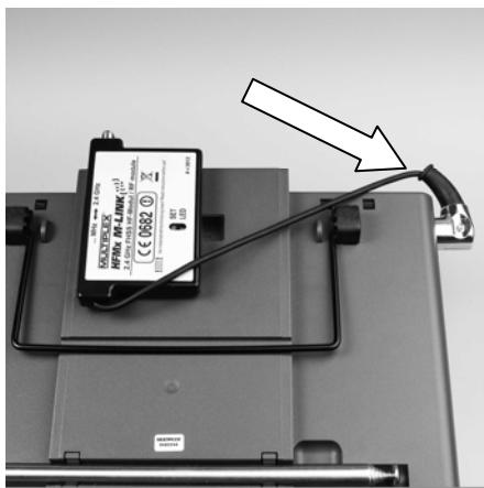
2. Bei ungünstigem Kabelaustritt am Stecker kann das Innenteil des DIN-Steckers (Kontakte samt Fassung) gedreht werden:
