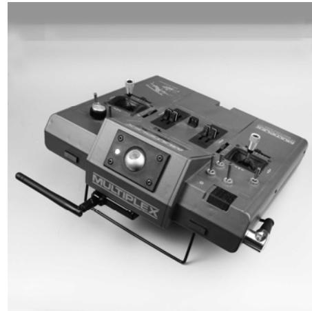
Bei Anwendungen, bei denen das Modell nicht direkt über dem Sender oder nicht direkt unter dem Sender betrieben wird (insbesondere bei Autos und Schiffen), ist eine Antennenstellung senkrecht nach oben optimal.
