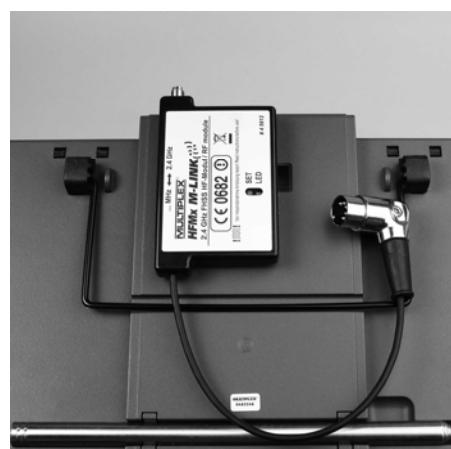
**6.3.: Conexión del módulo RF 2,4 GHz HFMx M-LINK a la clavija profesor / alumno de la emisora**
