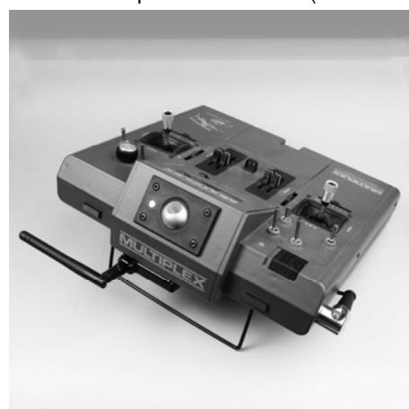
En usos en los que el modelo no se maneje directamente por encima de la emisora, o por debajo de esta (especialmente con coches o barcos), la colocación de la antena hacia arriba en vertical será la óptima.
