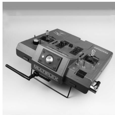
Pour les utilisations où votre modèle ne se trouve pas directement au-dessus ou en dessous de votre émetteur (surtout dans le cas des voitures et des bateaux), la position optimale de votre antenne d'émission est à la vertical vers le haut.
