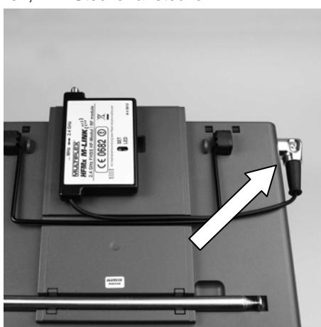
**6.4.: 2,4 GHz Antenne montieren**
