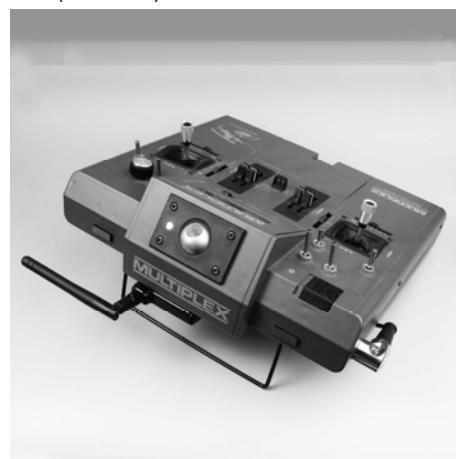
Per tutti quei campi d'impiego, dove il modello si trova direttamente sotto o sopra la radio (in particolare con automodelli e navi), posizionare l'antenna in verticale.
