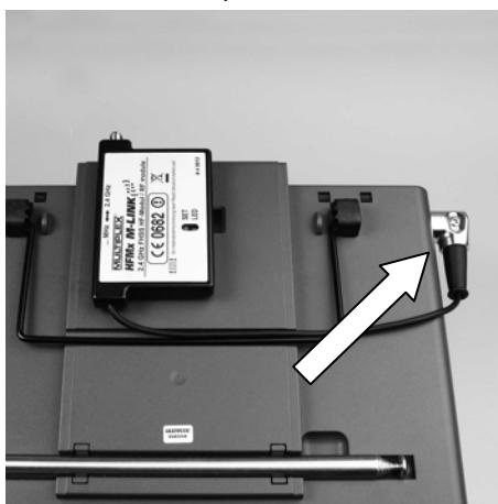
**6.4.: Mise en place de l'antenne 2,4 GHz**
