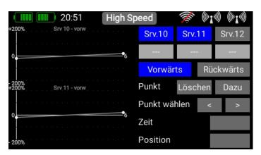
Unterhalb der **Srv.** Buttons sehen Sie zwei weitere Buttons: **Vorwärts** und **Rückwärts**. Auch diese Buttons dienen dazu, nur die Sequenzer-Graphen anzeigen zu lassen, die Sie gerade sehen oder bearbeiten wollen.
