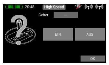
Als Geber können Sie einen Schalter oder einen Lineargeber verwenden. In beiden Fällen können Sie die Schaltpunkte und die Schaltrichtung einstellen. Dabei ist zu beachten, dass der grüne Bereich den Sequenzer **Vorwärts** laufen lässt, der rote Bereich **Rückwärts**. Dazu später mehr bei den Einstellungen der Wegpunkte.
