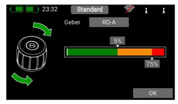
Jetzt können Sie die beiden Schaltpunkte durch Verschieben mit dem Finger beliebig anpassen. Der rote Bereich markiert den "Aus-Zustand", der grüne den "Ein-Zustand". Der orangene Bereich markiert die "Hysterese". In diesem Bereich erfolgt keine Umschaltung. Sie können den "Aus-Zustand" und den "Ein-Zustand" ganz leicht umdrehen, indem Sie einen der beiden Schaltpunkte Schieber vor oder hinter den anderen schieben.
