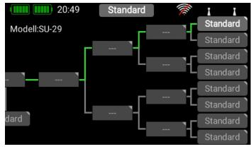
Das Wichtigste hierbei ist, zu wissen, dass der **ATOM** eine Priorisierung der Flightmodes vornimmt. Die Priorisierung nimmt von links nach rechts ab. Das heißt, die Flightmodes in dem Baum links haben die höchste Priorität, die rechts haben die niedrigste Priorität. Damit kann man bei komplexen Flightmode-Strukturen zum Beispiel mit einem einzigen Schalter alle anderen Schalterstellungen überstimmen und so beispielsweise ganz schnell in einen "Normalen" Flugmodus zurückschalten.
