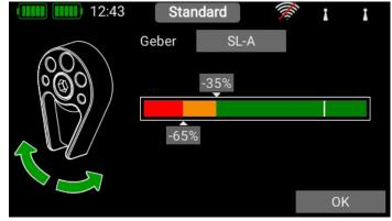
Wenn Sie einen linearen Geber ausgewählt haben, können Sie die beiden Schaltpunkte durch Verschieben mit dem Finger beliebig anpassen. Der rote Bereich markiert den "Aus-Zustand", der grüne den "Ein-Zustand". Der orangene Bereich markiert die "Hysterese". In diesem Bereich erfolgt keine Umschaltung. Sie können den "Aus-Zustand" und den "Ein-Zustand" ganz leicht umdrehen indem Sie einen der beiden Schaltpunkte Schieber vor oder hinter den anderen schieben.
