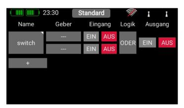
Wählen Sie im Menü den Button **Virtuelle Schalter** und drücken Sie auf + um einen neuen virtuellen Schalter anzulegen. Sie können den Virtuellen Schalter umbenennen indem Sie auf **switch** tippen. Wie Sie sehen können, hat dieses Feld ein kleines Dreieck oben rechts. Das bedeutet, dass hier eine Funktion durch längeres Antippen ausgewählt werden kann. In diesem Fall kann der virtuelle Schalter durch längeres Antippen der **switch**-Taste wieder gelöscht werden.
