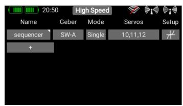
Drücken Sie in der Übersicht auf **Setup** um die Wegpunkte einzustellen. Sie finden den nächsten Bildschirm, wie hier gezeigt, vor. Das erste Servo ist markiert und die Sequenz **Vorwärts** und **Rückwärts** wird angezeigt. Die Standardlaufzeit beträgt 6.0 Sekunden, die beiden Wegpunkte stehen auf ±20%.
