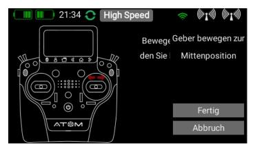
Wenn ein Lineargeber oder ein 3-Stufenschalter verbaut ist, müssen Sie den Geber jetzt noch in die Mitte bewegen. Drücken Sie auf Fertig. Mit der **Direkt**. -Taste können Sie die Wirkrichtung des Gebers umschalten.
