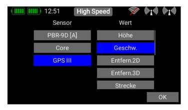
In der linken Spalte stehen alle angeschlossenen Sensoren und in der rechten Spalte alle Werte, die diese Sensoren beinhalten. Der eigens entwickelte **P²BUS** kann bis zu 255 Sensoren mit je 32 einzelnen Werten übertragen – und das mit einer Geschwindigkeit von bis zu 800 Werten pro Sekunde!
