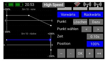
In diesem Beispiel würde die Türe 1 Sekunde lang stehenbleiben, dann mit einer Laufzeit von 1 Sekunde von -100% nach +100% fahren. Nach 2 Sekunden Wartezeit würde die Türe wieder mit 1 Sekunde Verzögerung von +100% nach -100% fahren. Nach einer weiteren Sekunde ist die Sequenz abgeschlossen.
