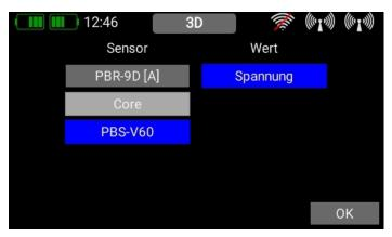
In diesem Beispiel soll der **PBS-V60** Spannungssensor dazu verwendet werden die Motorleistung zu drosseln, wenn der Akku leer wird. Sie können dem Telemetrie Geber unter dem Feld **Name** umbenennen.
