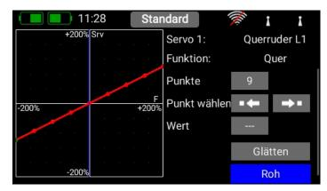
Wählen Sie hierzu mit Hilfe der Pfeiltasten den Punkt aus, den Sie verstellen wollen. Tippen Sie bei Wert auf die angezeigte Einstellung und stellen Sie das Servo an dieser Position ein. Mithilfe des Glätten Buttons können Sie den Kurvenverlauf weicher machen. Ganz unten finden Sie einen Reset Button, der die Kurve wieder zu einer linearen Gerade zurücksetzt. Haben Sie Ihre Kurve eingestellt, gehen Sie zurück in das Servokurven-Menü. Hier finden Sie die drei Vorschau-Buttons:
