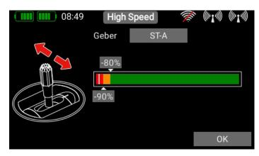
Jetzt können Sie die beiden Schaltpunkte durch Verschieben mit dem Finger beliebig anpassen. Der rote Bereich markiert den "Aus-Zustand", der grüne den "Ein-Zustand". Der orangene Bereich markiert die "Hysterese". In diesem Bereich erfolgt keine Umschaltung. Sie können den "Aus-Zustand" und den "Ein-Zustand" ganz leicht umdrehen, indem Sie einen der beiden Schaltpunkte Schieber vor oder hinter den anderen schieben.
