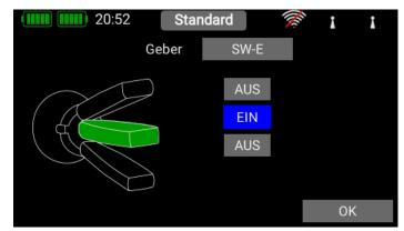
Nachdem Sie verschiedene Flightmodes angelegt haben, sehen Sie im Flightmode-Baum anhand der grünen Striche, welcher Flightmode gerade aktiv ist. Jetzt können Sie im Geber-, Trimm- und Mischer-Menü verschiedene Einstellungen für die unterschiedlichen Flightmodes einstellen, indem Sie bei der Flightmode-Einstellung Single wählen.
