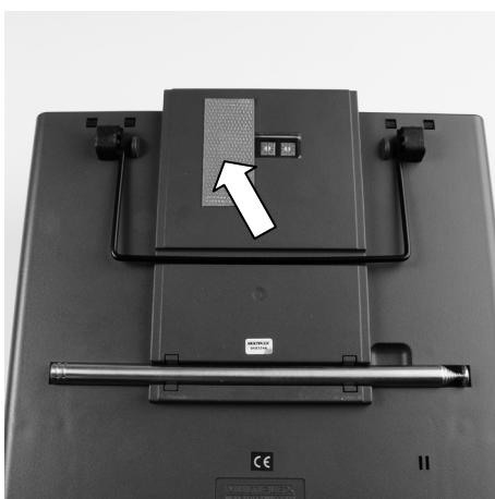
3. Fixez le **module HF 2,4 GHz HFMx V2 M-LINK** au boîtier de l'émetteur:
