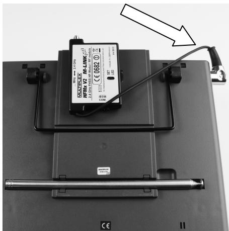
2. Nel caso in cui, il cavo non dovesse uscire dalla presa in direzione ottimale, ruotare la parte interna della spina DIN (contatti e portacontatti):
