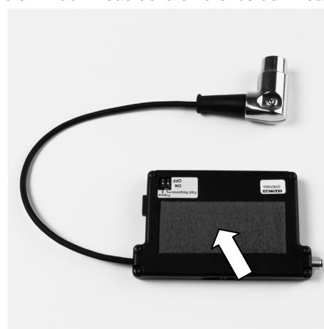
2. Collez l'autre partie de la bande velcro (crochets) à l'emplacement choisi sur le boîtier de votre émetteur:
