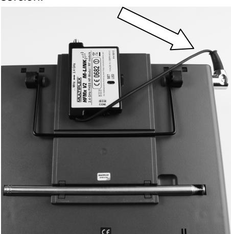
2. Si la salida del cable del conector no fuese de su agrado, puede girar la parte interna del conector DIN (contactos y montura):
