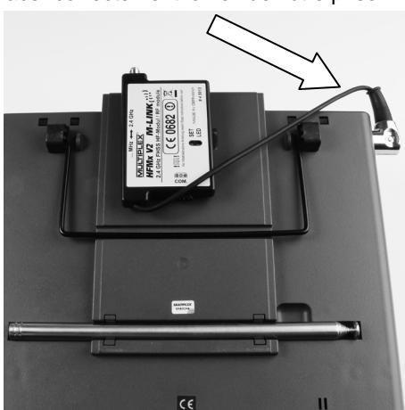
2. Si l'orientation de la sortie du câble de la prise est défavorable, vous pouvez tourner la partie interne du connecteur DIN (contacts avec corps).
