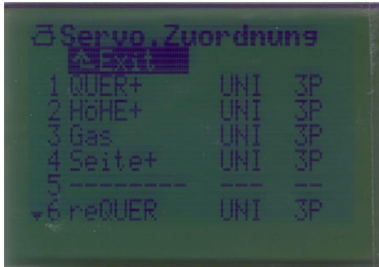
Alle Servo sollten zuerst auf 3Punkt-Servos (3P) eingestellt werden, sollte aber für die korrekte Servokalibrierung und Servowegeeinstellung eine Änderung notwendig sein, kann diese vorgenommen werden.
