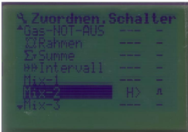
Im Setup-Menü weisen Sie den Software-Schalter MIX2 dem seitlichen Bedienelement „H“, wie oben abgebildet, zu.
