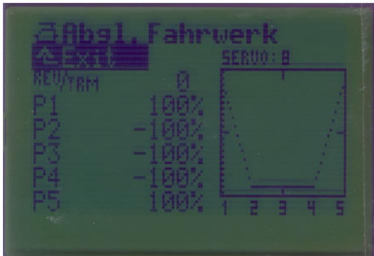
Verlassen Sie das Menü und wählen Sie das Servo aus, welches der Fahrgestellsabdeckung zugewiesen wurde und drücken Sie ENTER.
