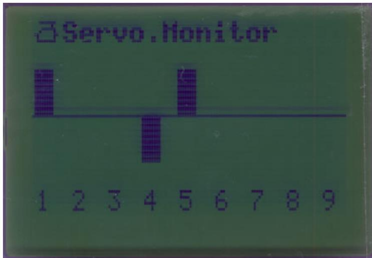
Betrachten Sie diesen Bildschirm. Kanal 4 (der Motor-Geber) wurde in seine unterste vertikale Position verschoben.
