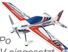
Im Acromaster wird ein 3s LiPo mit einer Spannung  $U = 12,6V$  eingesetzt. Bei Vollgas fließt durch den Stromkreis ein Strom von  $I = 40 A$ . Der Motor bekommt vom Akku also eine elektrische Eingangsleistung von
