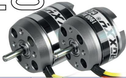
Motoren der 28mm-Klasse werden für Parkflyer bis 1kg und „Hutablagenflieger“ eingesetzt. Die Antriebkonzepte basieren dabei auf Akkus mit 2 und 3 Lipo-Zellen. Typische Anwendungen sind Nurflyer wie der Xeno mit Speed Auslegung oder der Parkmaster mit 3D Setup. Aufgrund seines schmalen Durchmessers und der hohen Leistung, eignet sich der C2834 hervorragend als Antrieb in den dünnen Rümpfen widerstandsrmer Segler bis 1,5kg.
