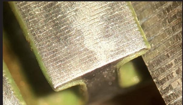
ROXXY verwendet extrem dünne 0.2mm Statorbleche, dadurch werden bremsende Wirbelströme unterdrückt.
