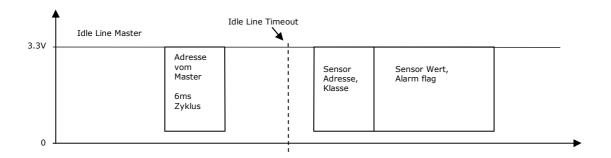
Der Sensor ist Slave. Er empfängt so lange Bytes, bis ein Idle Line Timeout auftritt. Nach dem Timeout interpretiert der Sensor die Anzahl und Inhalt der empfangenen Bytes. Hat er genau ein Byte empfangen und ist dies eine im Sensor eingetragene Adresse oder ein Broadcast-Befehl, reagiert der Sensor und sendet seine Antwort, bzw. reagiert auf den Befehl (siehe Kapitel 3.8 Adressen / Befehle).
