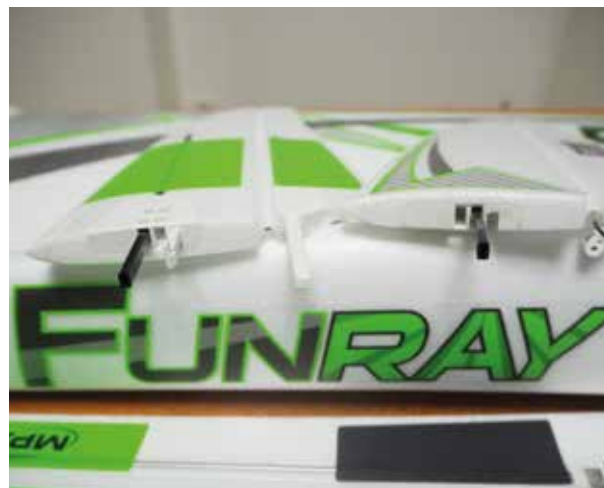
◀▶ Steck-bares Höhenleitwerk mit CFK Holm und Schnappbefestigung.
