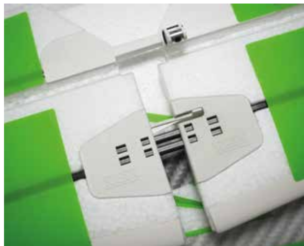
◀▶ Steck-bares Höhenleitwerk mit CFK Holm und Schnappbefestigung.
