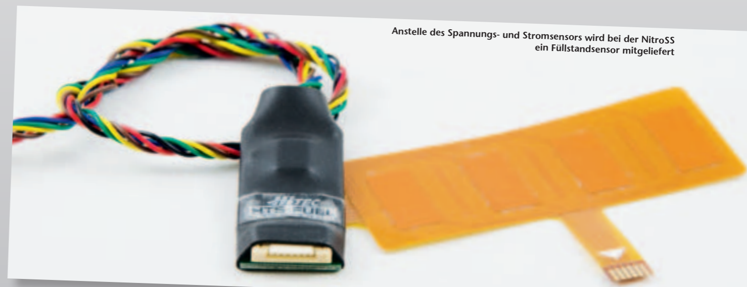
HTS-Navi zur Übertragung der Sensordaten an den PC inklusive Speicherung derselben
