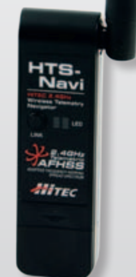
HTS-Navi zur Übertragung der Sensordaten an den PC inklusive Speicherung derselben
