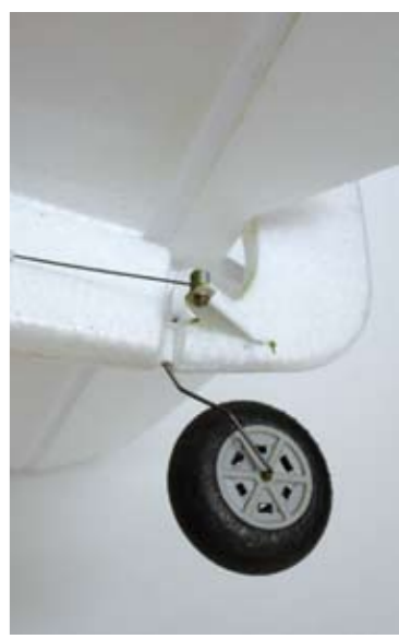
Das Spornrad ist etwas nach hinten gebogen. Das Wasserruder kann so noch nicht montiert werden
