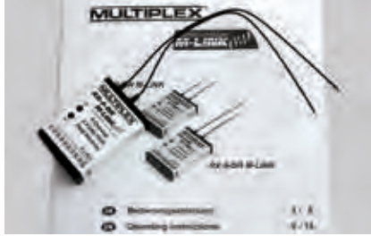
RX-9-DR-M-Link-Empfänger mit zwei unabhängigen Empfangseinheiten
