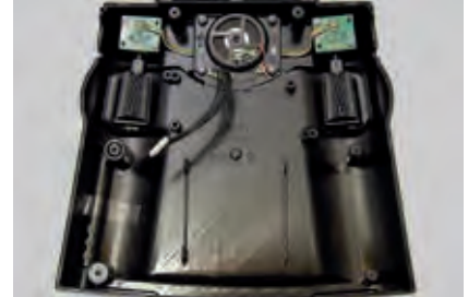
Gehäuse-Unterschale mit Geber-Walzen und Lautsprecher
