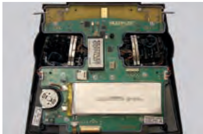
Saubere Verarbeitung mit auf das Notwendigste reduzierter Verkabelung
