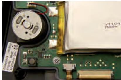
Motor für Vibrationsalarm neben eingelötetem 4.000-mAh-LiFe-Akku
