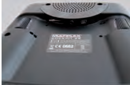
Sender-Rückseite mit Geber-Walzen, Mini-USB, Kopfhörer-Buchse und Torx-Schlüssel
