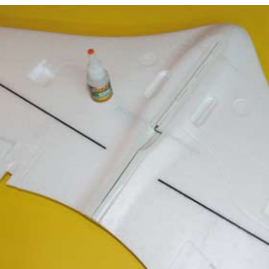
Carbon-Profile verleihen dem Modell ausreichend Festigkeit
