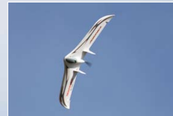
Auch im Rückenflug geht der Xeno durch die Figuren, muss aber mit ordentlich Tiefenruder gehalten werden
