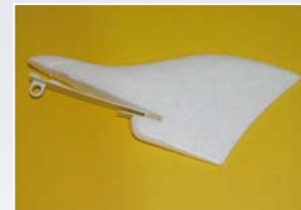
Auch so eine clevere Idee: Die Mini-Seitenleitwerke sind abnehmbar gestaltet und rasten ohne Werkzeug ein
