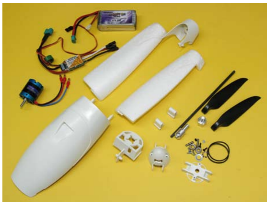
Durch den Druckantrieb mit Fernwelle sind auch im Antriebsset neben Motor, Regler und Akku einige Kunststoff- und Hartschaumteile enthalten
