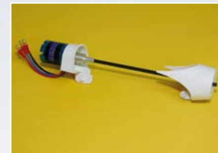
Der Außenläufermotor treibt die Luftschraube aus Schwerpunktgründen über eine Carbon-Fernwelle an
