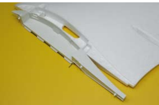
Durch eine zweiteilige RC-Wanne wird der Nurflügel über einen Stahldraht teilbar gemacht
