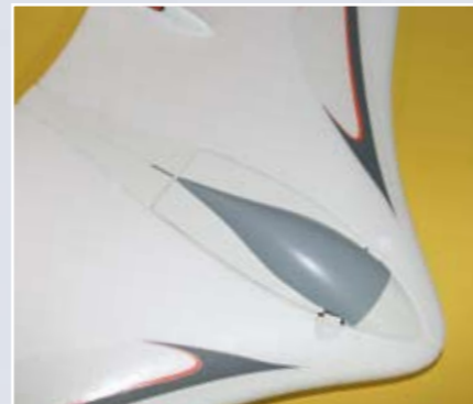
Die Seglerhaube ist deutlich schlanker und niedriger gestaltet und bietet weniger Widerstand als die Haube der Elektroversion
