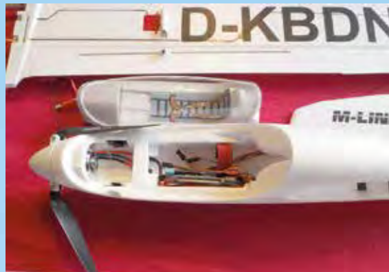
Detail Kabinenhaube mit Cockpit und Abdeckung Servohebel
