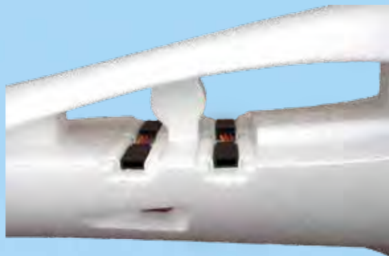
Detail Elektrischer Anschluss Querruder / Wölbklappe
