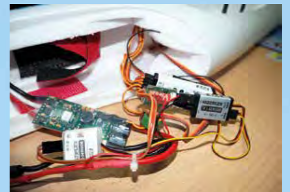
Empfänger + Sensoren für Strom, Spannung und Vario V-Speak
