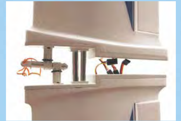
Detail Flächenverbinder und Verriegelung mittels Zapfen
