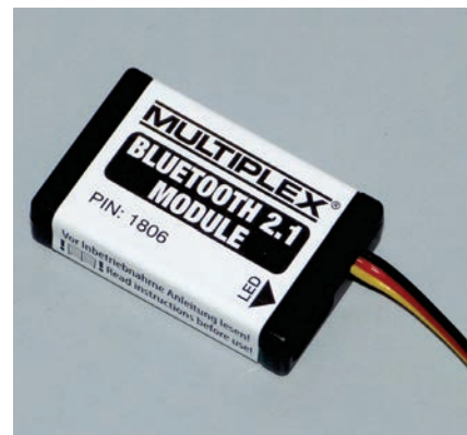
Le module Bluetooth optionnel permet de programmer le Wingstabi sans câble USB-PC, avec une tablette ou un smartphone, directement sur le terrain.
