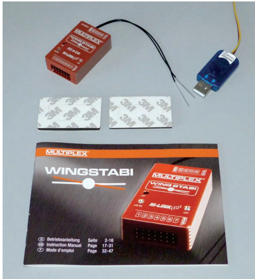
Le contenu du coffret, un cordon USB est livré pour programmer le Wingstabi avec un PC.
