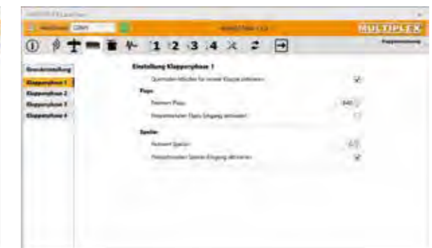
Einstellwerte für Klappenphase Speed, Flap und Querruder wird um 1 mm nach oben aus dem Strack gestellt.
