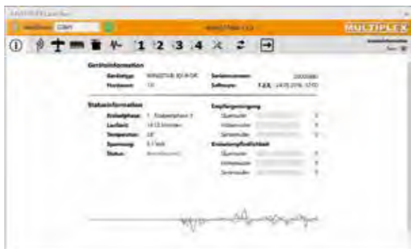
Im Menü Geräteinformation werden wichtige aktuelle Werte angezeigt. Auf der unteren Linie sind die Korrekturen des Kreisels bei Bewegung des Modells zu sehen.
