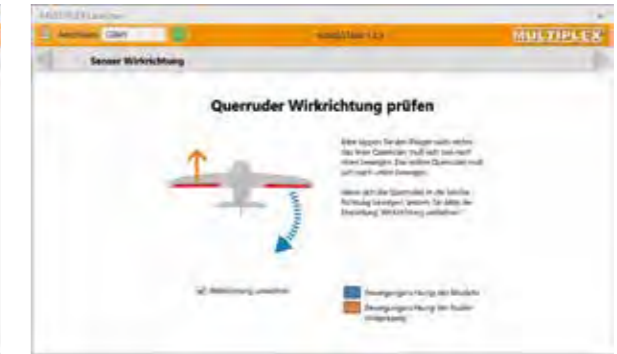
Überprüfung der Kreiselwirkung ist für Quer, Höhe und Seite durchzuführen.
