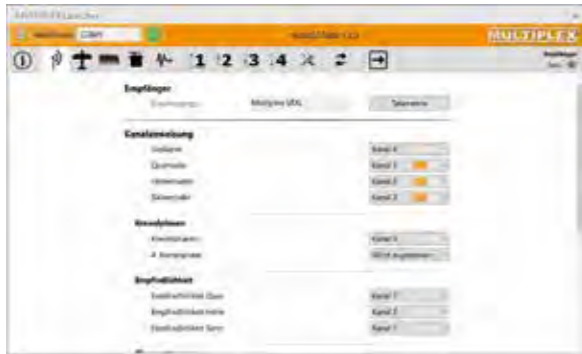
Im Menü Empfänger können die zugeordneten Servoausgänge des Senders kontrolliert werden.
