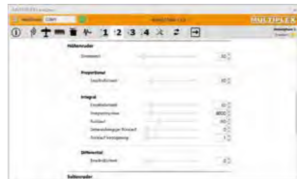
Einstellwerte der Kreiselphase 2 im erweiterten Menü für das Höhenruder, analog dazu gibt es die Werte für Quer und Seitenruder.
