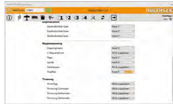
Im Menü Empfänger können die zugeordneten Servoausgänge des Senders kontrolliert werden.
