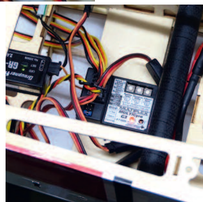
Der MULTIGyro wurde im HoT Trigger ausgiebig getestet. Die LEDs signalisieren, ob Dämpfung oder Heading-Modus eingestellt oder der Kreisel ausgeschaltet ist.
