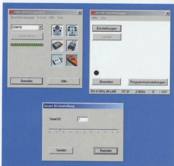
Die FLEXX-Empfänger werden über das Programm MPX-Launcher mit einer ID versehen, mit der sie an einen bestimmten Speicherplatz des FLEXX-Senders gebunden werden
