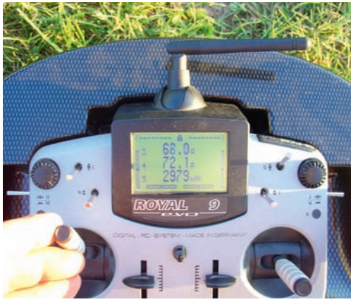
Das Display beim Start: Der momentan fließende Strom beträgt 68 A, der max. Strom beim Einschalten 72,1 A, die Kapazität des Antriebsakkus 2.979 mAh.
