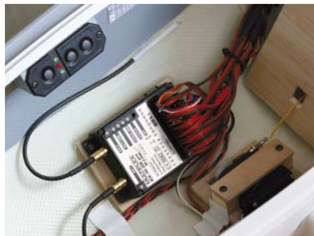
16-Kanalempfänger in einem Ventus 2cM. Die beiden Antennen werden in kurzen Bowdenzugrohren an der Rumpffinnenseite fixiert
