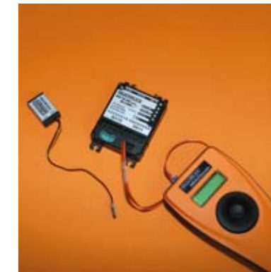
Sowohl die Empfänger, als auch die Sensoren lassen sich per Multimate konfigurieren
